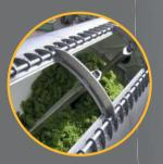
Srande ouverture de remplissage sur toute la longueur du cylindre de pressurage (trémie en option)
