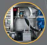
Centrale de commande avec écran tactile et soufflerie réversible pour une commande de la pression en amont et de l'évacuation très efficace et rentable (en option : compresseu intégré)
